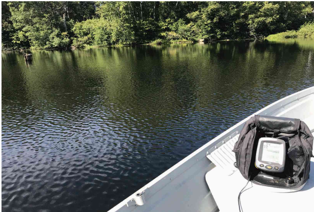
Planche 1. Vue du sonar « Humminbird Onehundred » utilisé lors de la réalisation du levé bathymétrique sur le lac Perché le 15 août 2025
