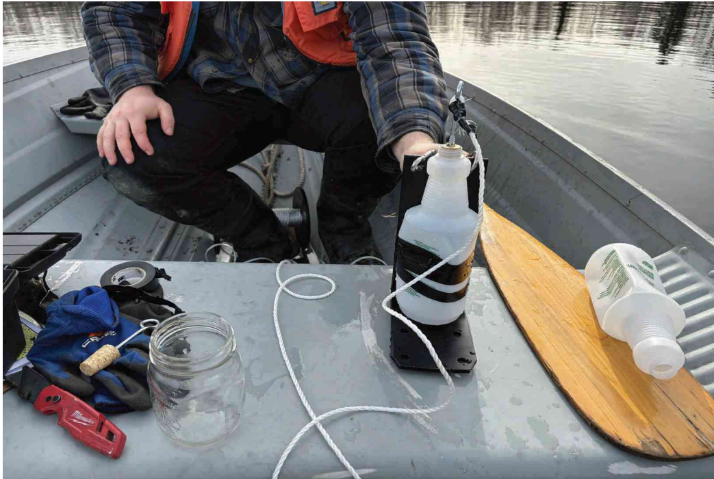
Planche 9. Vue de l'équipement d'échantillonnage spécialement fabriqué pour prélever des échantillons d'eau à différentes profondeurs au sein du lac Perché
