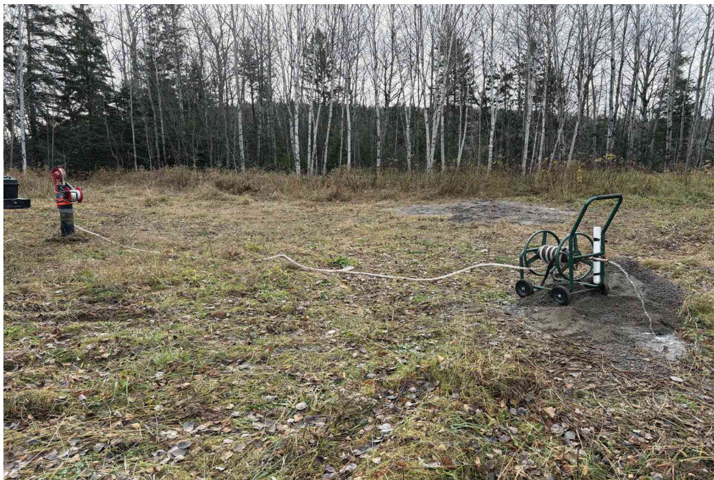
Planche 10. Vue des équipements de pompage qui ont été utilisés pour purger et échantillonner l'eau souterraine des piézomètres MB-1, MB-2, MB-3, MB-4 et PZ-3/98
