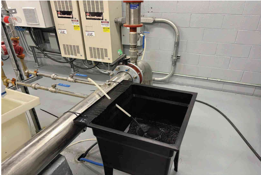
Planche 11. Vue de l'eau souterraine brute provenant directement des puits de captage P-1 et P-2 qui s'écoule dans le bassin avant la prise des échantillons
